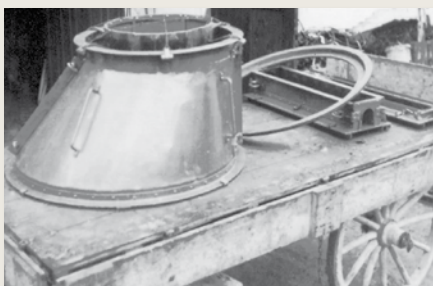
Une charrette sert à enlever un moule conique et un moule rigole - env. en 1920
