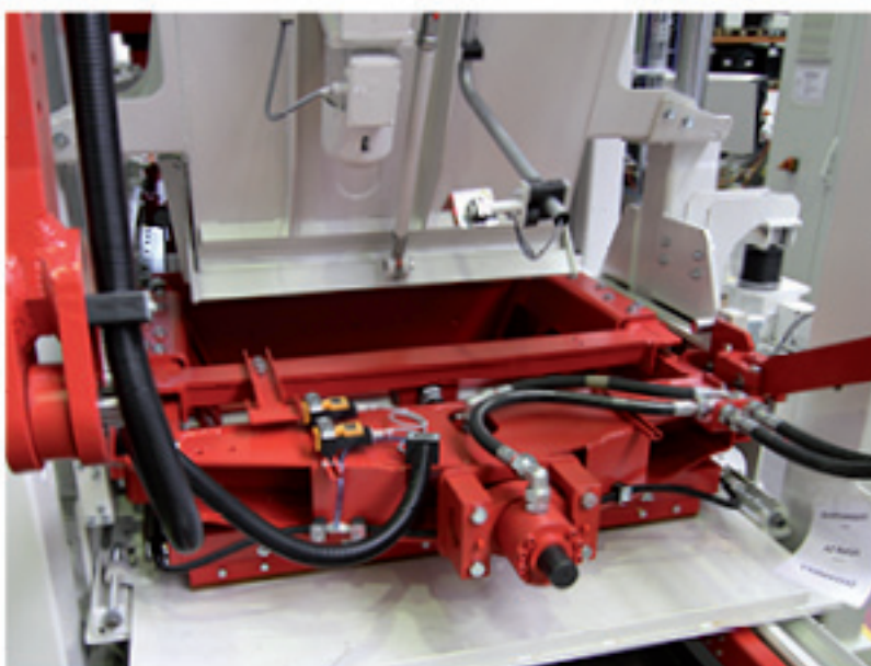
Carro de llenado con control de nivel y accionamiento de agitador.
