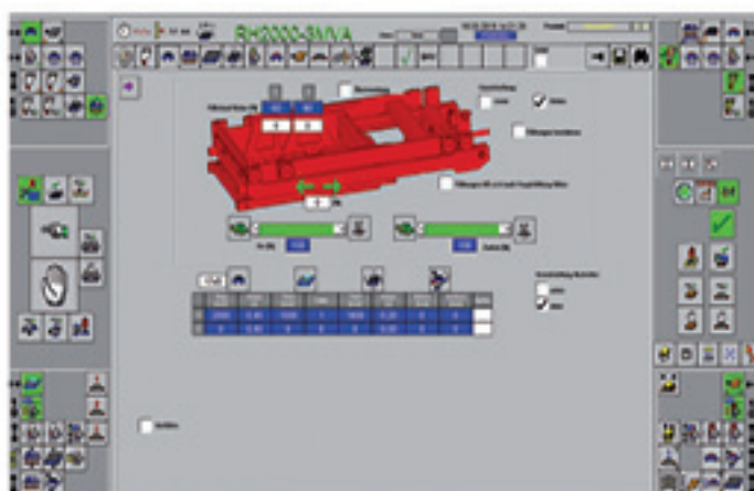
Mando de carro de llenado por controles deslizantes
