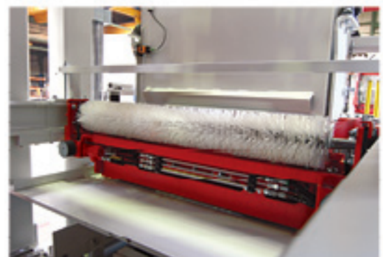
Tiroir de remplissage de béton fin avec rouleau de lissage Racleur pneumatique et brosse rotative (option)
