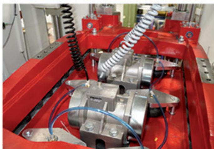
Vibrateur de charge (en option)
