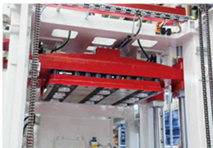
Plaque de charge caoutchoutée (standard)
