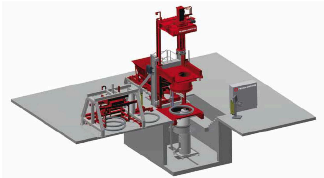
Die Produktion von Rohren und Schachtelementen auf der gleichen Maschine bietet dem Fertigteilhersteller die Möglichkeit seine Produktion flexibel zu gestalten. Die MISTRAL bietet eben diese Möglichkeit, wobei diese Anlage selbstverständlich auch nur für eine dieser Produktlinien eingesetzt wird. Darüber hinaus lassen sich eine Vielzahl anderer Produkte auf der MISTRAL herstellen.
