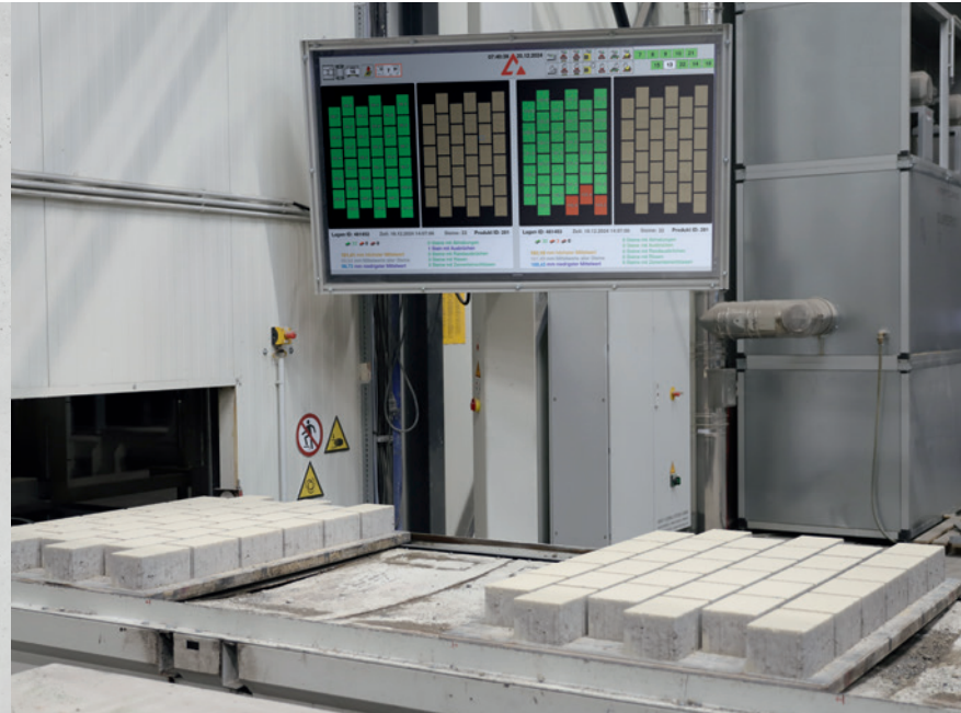
Fehlermarkierung orange: Abhebung
