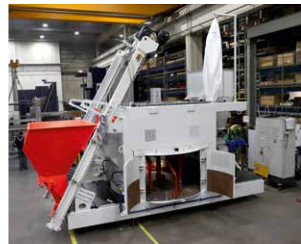
Смеситель SM 2250 с большими дверями для очистки и обслуживания
