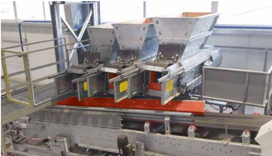
Система Professional: Дозировка облицовочного бетона с тремя бункерами
