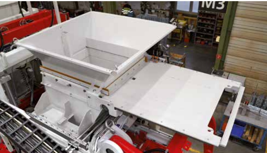
Система Advanced: Установка дополнительной насадки на бункер с выдвигающимся листом
