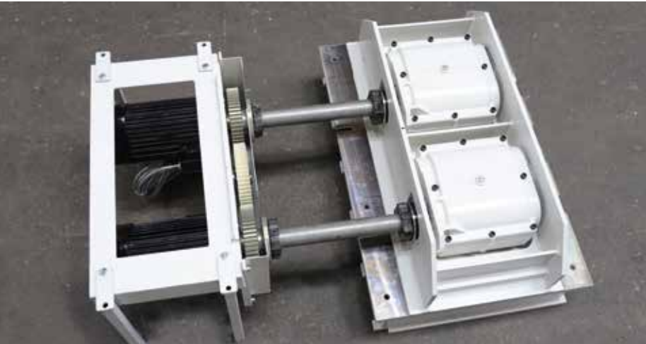
Ölbadrüttler als Kompaktrüttler für kleine Fertigungsflächen optimiert, Ausführung wartungsarm
