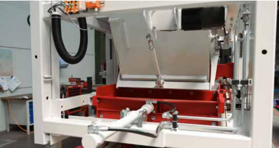
Hydraulisch angetriebene Füllwagen in der RH 500-3 für höchste Qualität auch bei kleinen Fertigungsflächen
