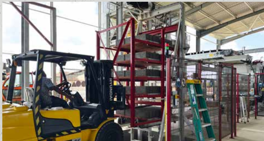
Entnahme der Fertigungsunterlagen mittels Staplergestellen aus Hubgerüst
