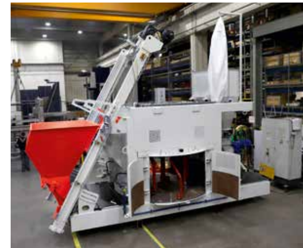
Mischer SM 2250 mit großdimensioniertem Zugang zur Reinigung und Wartung
