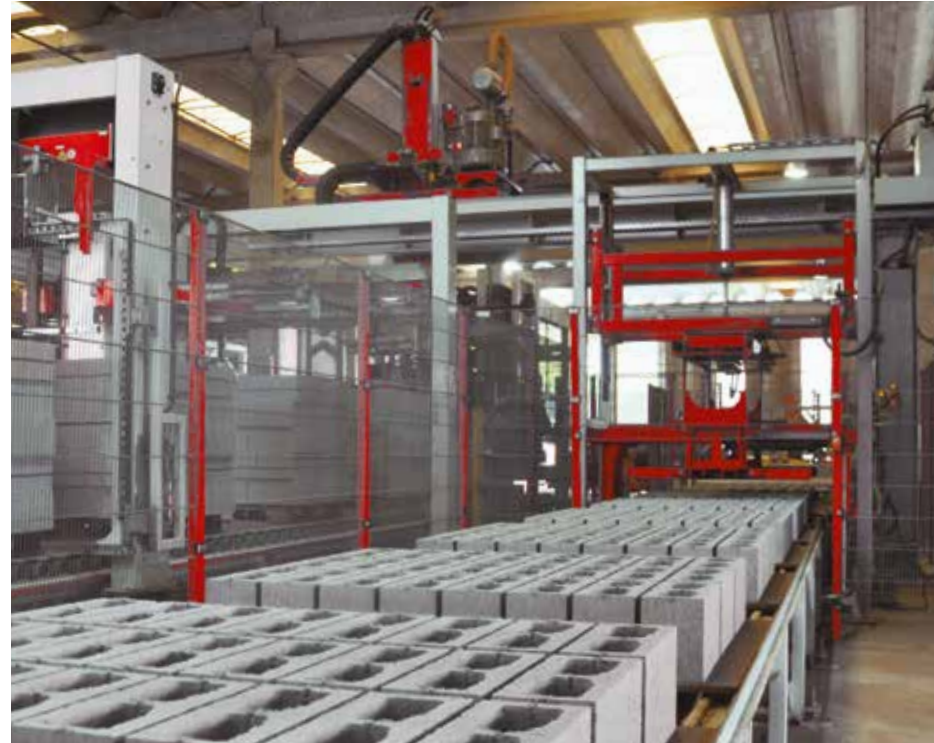
Trockenseite mit Hohlblocksteinen
