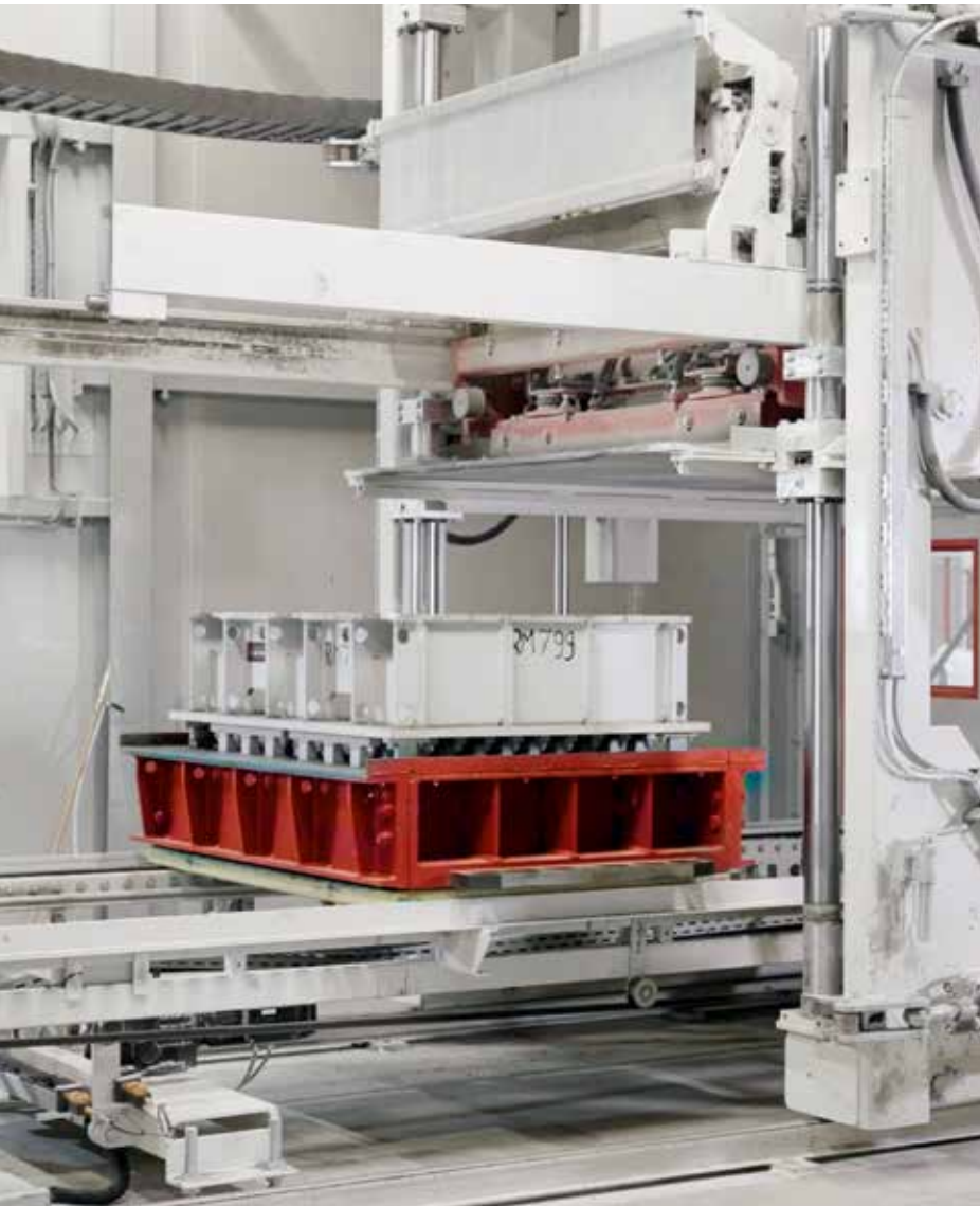
Hydraulisches Anhubsystem der Kern- und Vorsatzteile
