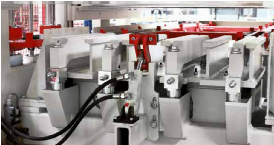
Вибростол RH 500 с ударными планками, для оптимального уплотнения высококачественных бетонных изделий
