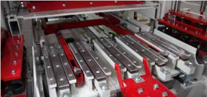
Вибростол с 5 ударными планками, для оптимального уплотнения высококачественных бетонных изделий
