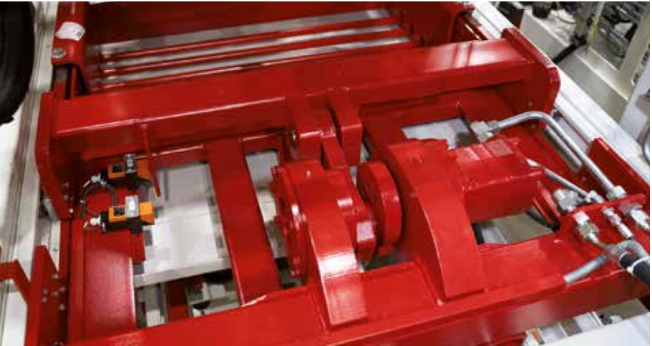
Привод колосниковой решетки для оптимального заполнения формы и уменьшения времени цикла
