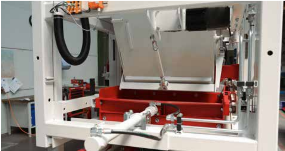
Трансферкара с приводом от гидроцилиндра в RH 500, для изделий высшего качества при не большой площади формования
