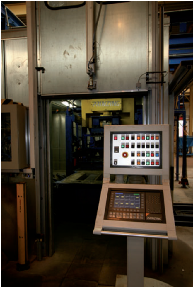
Auf den Monitoren des Steuerungspults der Blizzard lassen sich alle Produktionsparameter überwachen
