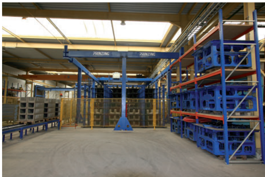
In Roeselare wurde bei der Anlagenplanung die Option auf eine Vergrößerung des Härteregals für einen eventuellen 2-Schicht-Betrieb berücksichtigt
