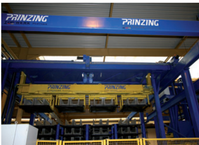
Dank des ausgeklügelten Kranroboter- und Regalkonzepts ist für die gesamte Anlage nur ein geringer Platzbedarf erforderlich.
