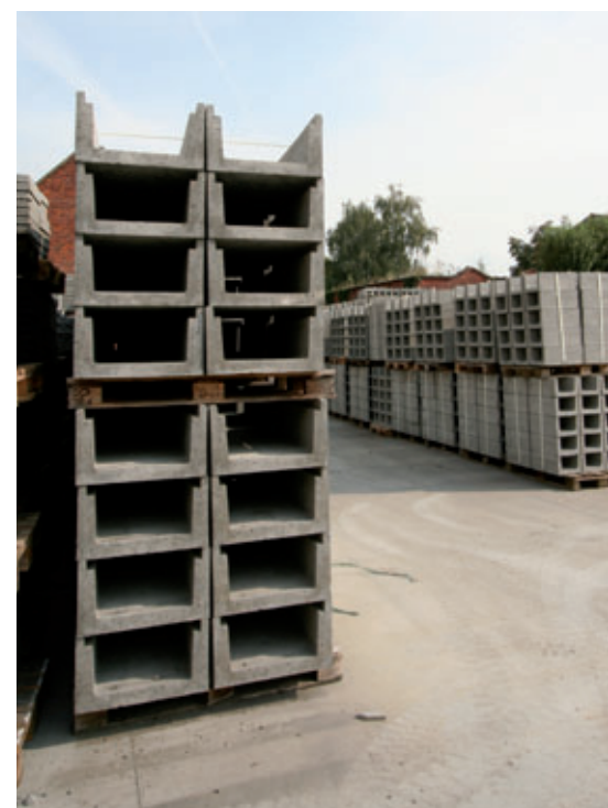
Kabelkanäle für die belgische Eisenbahn
