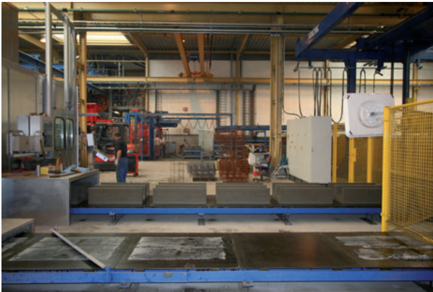
Im Hintergrund werden die frischen Betonprodukte aus der Fertigung zum Lager transportiert, im Vordergrund werden die entladenen Paletten über die automatische Palettenreinigung dem Produktionskreislauf wieder zugeführt
