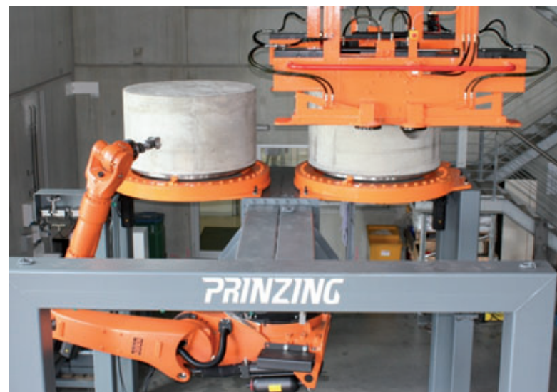
Die Monolithen werden noch auf dem Stahlendring ruhend in teilerhärtetem Zustand auf der Frässtation abgesetzt und genau zentriert
