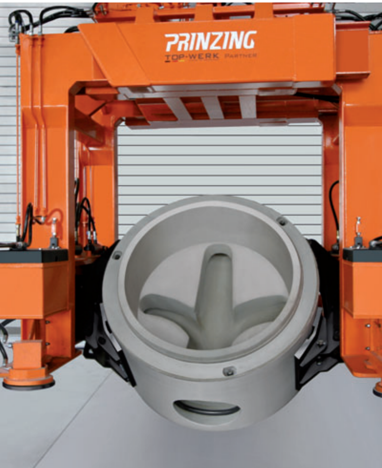
Das Wenden der Schachtunterteile in die natürliche Lage erfolgt deshalb direkt nach dem Fräsvorgang
