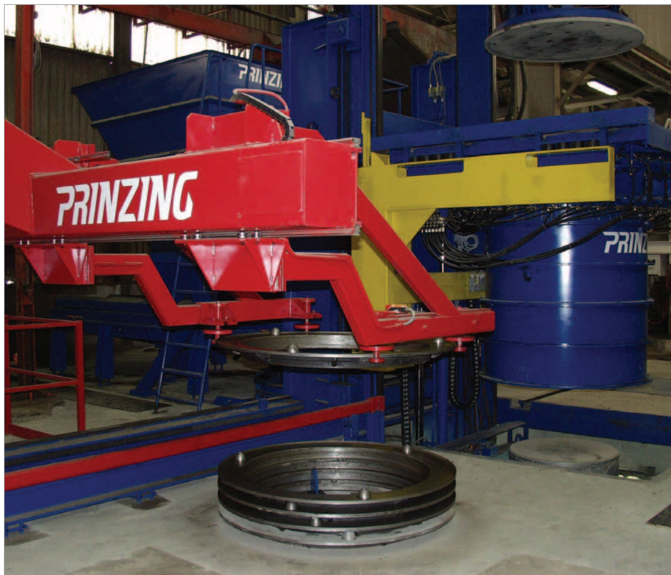
Eine spezielle Software steuert die automatische Herstellung der Schachtunterteile
