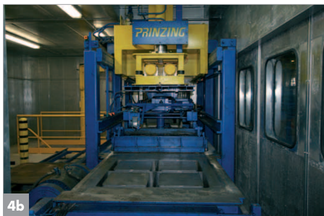
Schallschutzkapselung mit automatischen Türen
