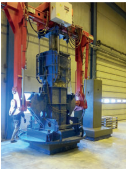
Entschalen am Abbindeplatz
