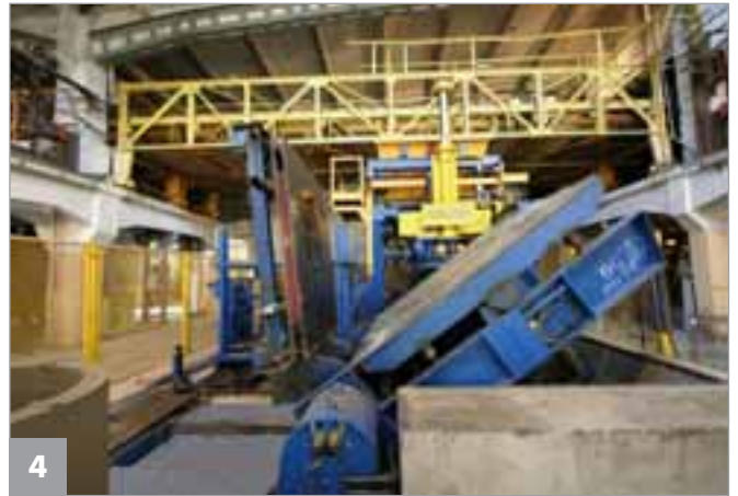
Herstellung der Schachtunterteile und Schachtoberteile im Wendeverfahren mit nur einer Form
