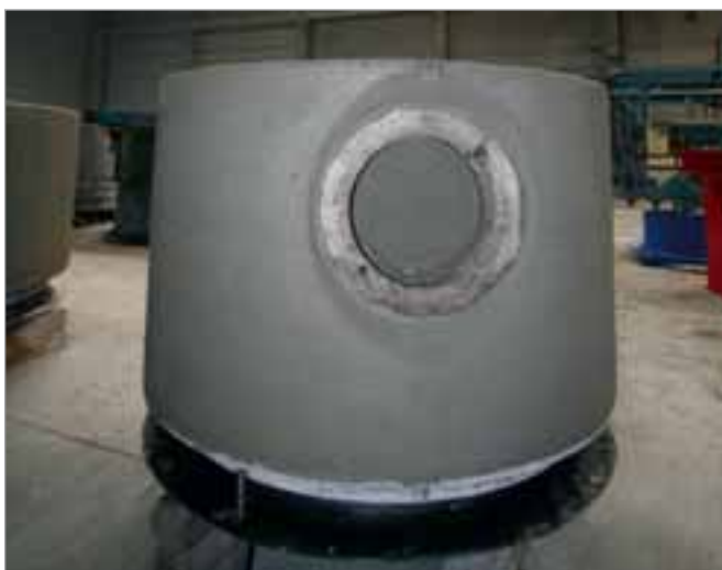
Das monolithische Schachtunterteil befindet sich bei der Fertigung und beim Weitertransport in umgekehrter Lage auf Untermuffen und Stützkernen ruhend.
