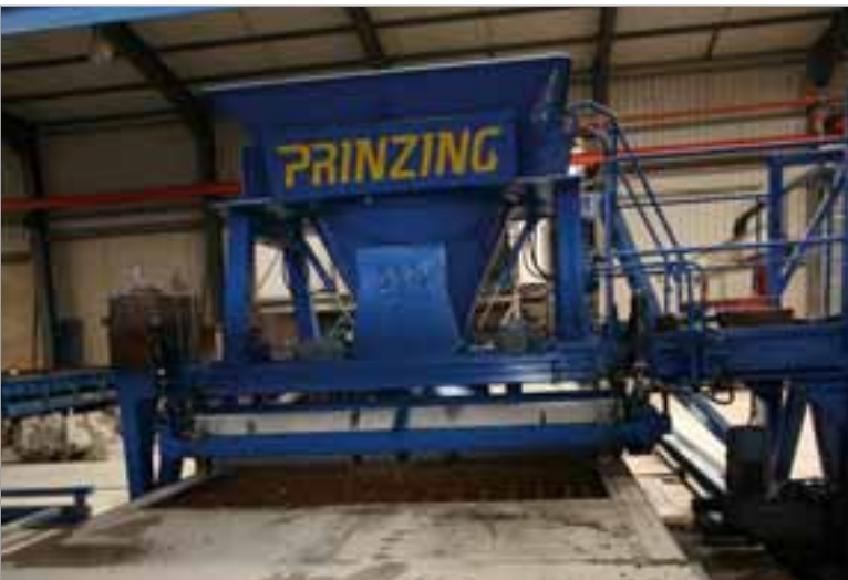
Beschickungsanlage für das Rüttelwalzverfahren für Normalbeton
