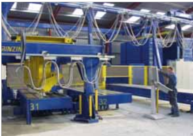
Automatisches Befüllen der Systemformen mit SVB
