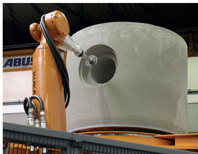
Die Betonfräse Primuss fräst millimetergenaue Läufe und Rinnen in Schachtunterteile.
