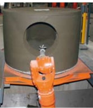
Fig. 1 Milling of connections. Abb. 1 Fräsen der Anschlüsse.
