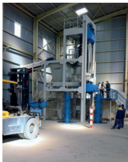
Radialpresse RP 1225 Hochleistungsmaschine für Abwasserrohre mit integrierter Dichtung DN 300-1200 mm, BL 2,5 m bei Sarl Eiber, Bouira
